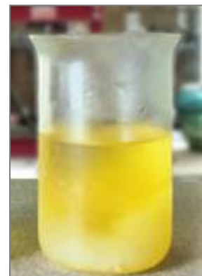
Рис.1 Кристаллизация парафинов в дизельном топливе
